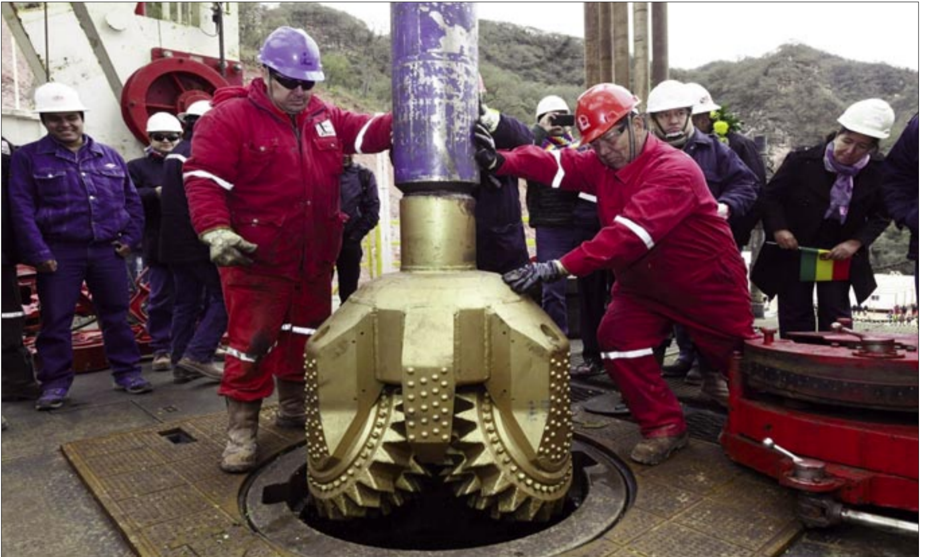
DE ESTA FORMA INICIARON LA PERFORACIÓN DEL POZO BERMEJO X-46, SEGÚN YPFB
